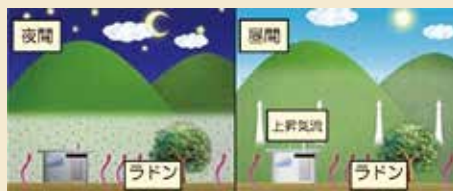
【左：夜間、地表付近に天然放射性物質が溜まるイメージ図】 【右：昼間、上昇気流により天然放射性物質が拡散するイメージ図】
