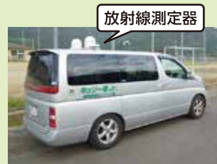
【走行サーベイに利用するモニタリングカー（キュリー号 Jr.）】
