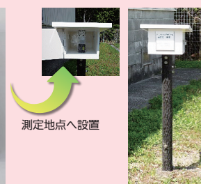
【電子線量計を設置する収納箱】
