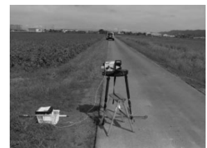
図5 可搬型 Ge 半導体検出器（車両外設置）
