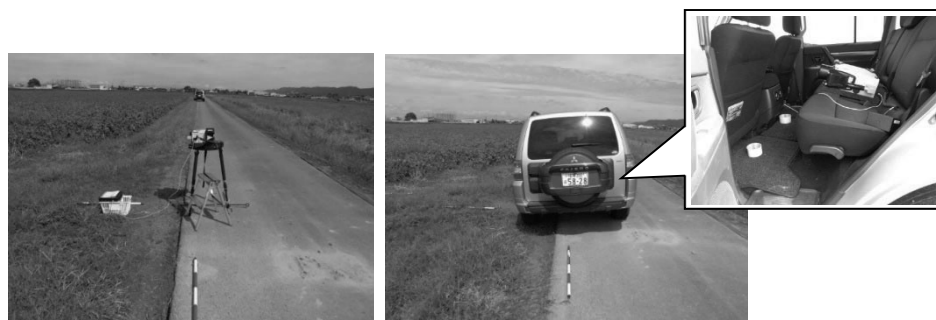
図12 車両内外における \gamma 線スペクトル測定
