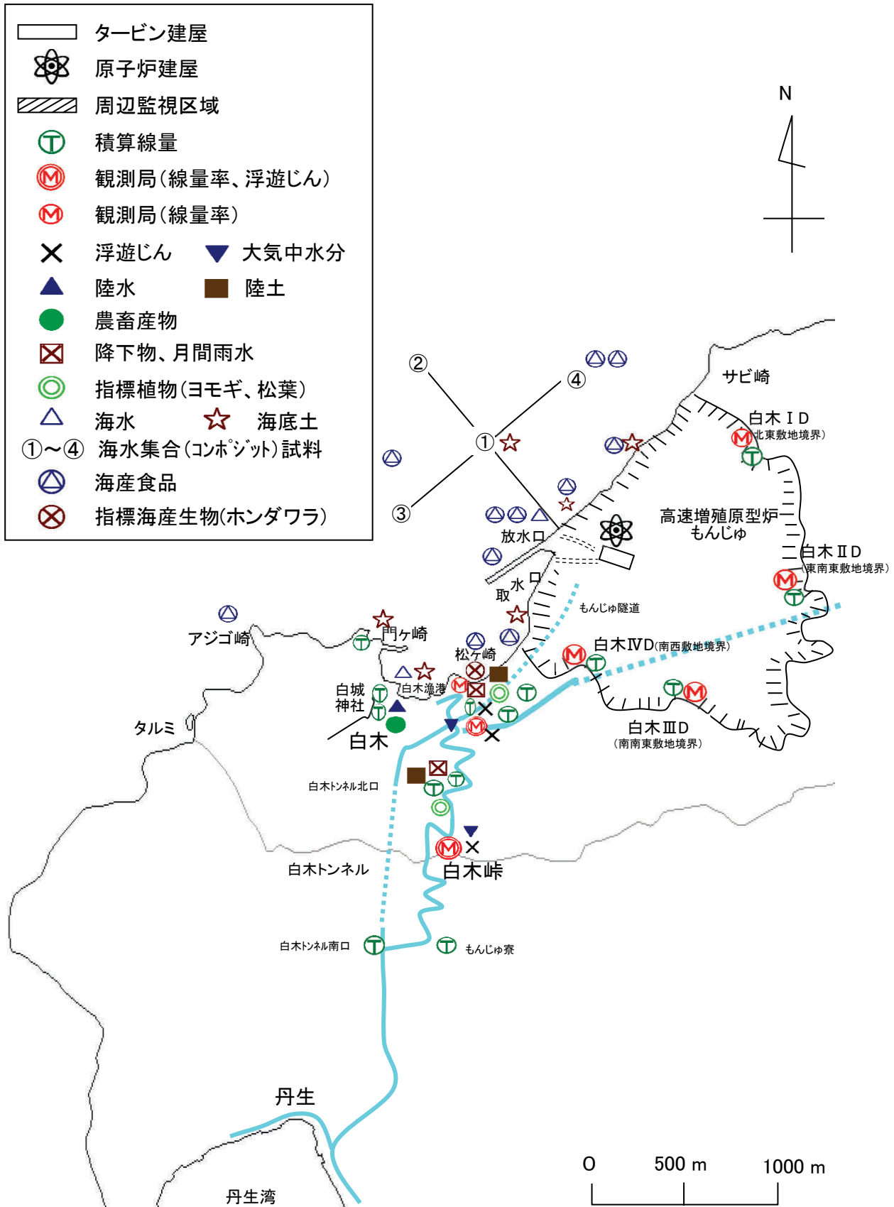
図3-2-2 環境試料採取地点 その2 高速増殖原型炉もんじゅ周辺
