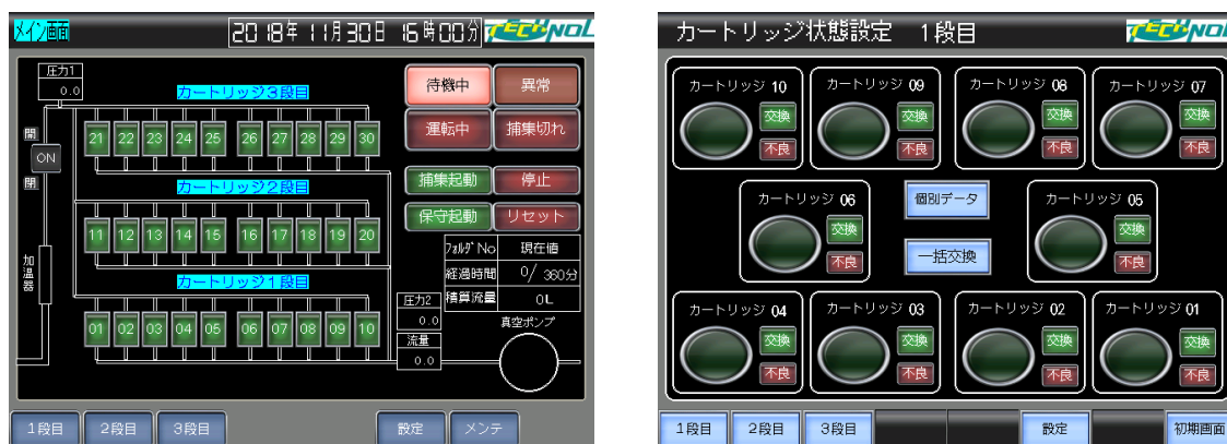
図-7 ヨウ素サンプラの系統および捕集材状態確認画面
