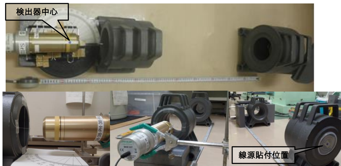
図-1 方向特性評価時の検出器の配置方法
