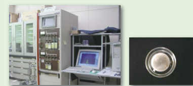
【α線測定用シリコン半導体検出器と測定試料】
